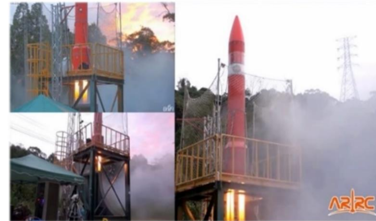
完成第二節火箭垂直組裝及全時程垂直點火地面測試 (2021/11/3)
