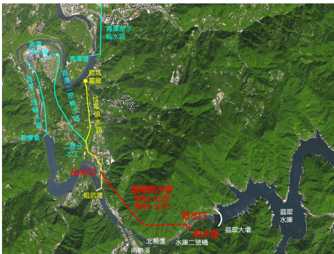
圖 1-1 翡翠原水管工程計畫配置圖
