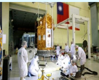
衛星與載具 分離測試 104年8月
