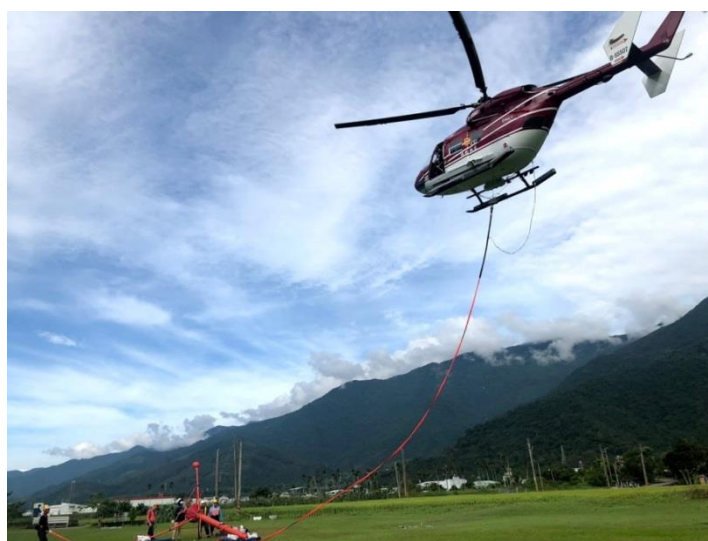
圖4-3 空中磁力探測工作之情形，執行團隊全由本國技術人員組成，執行吊掛的直昇機亦為國內航空公司所有。
