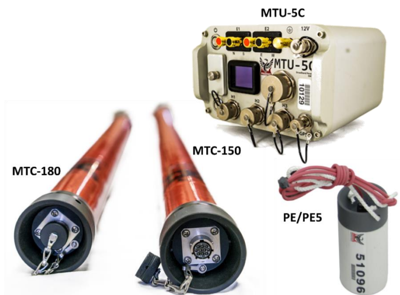
圖 10-4 本計畫預計使用的 Phoenix MTU-5C 超寬頻大地電磁系統
