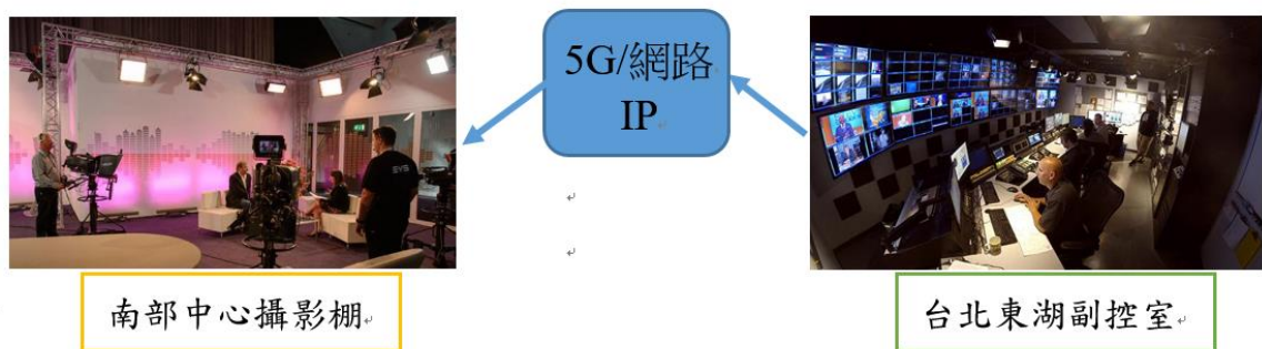
圖 4 公視以多屏跨螢 5G(或固網)網路進行台北<->南部兩地遠端遙控的作業模式
