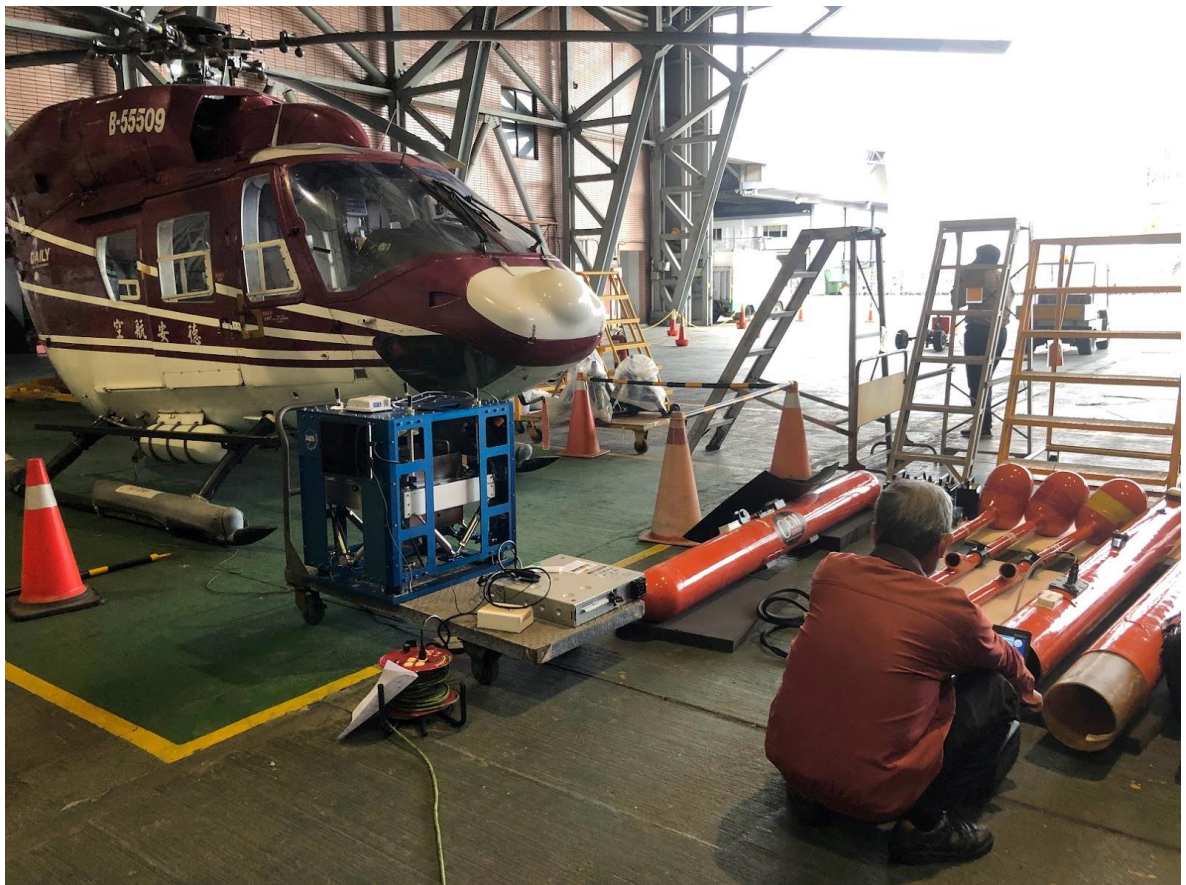
圖 9 直升機裝載高精度重力儀(直升機旁藍色設備)，結合磁力拖鳥(圖右橘色設備)進行空中重力磁力聯合調查
