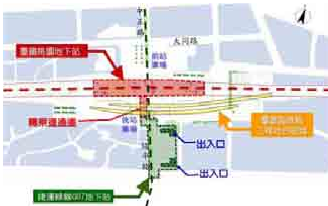
圖 5.2-5 臺鐵桃園站與捷運綠線 G07 站分構方案平面圖
