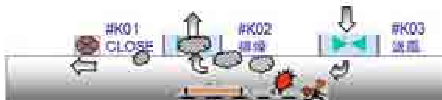
圖 5.3-3 隧道通風緊急運轉模式
