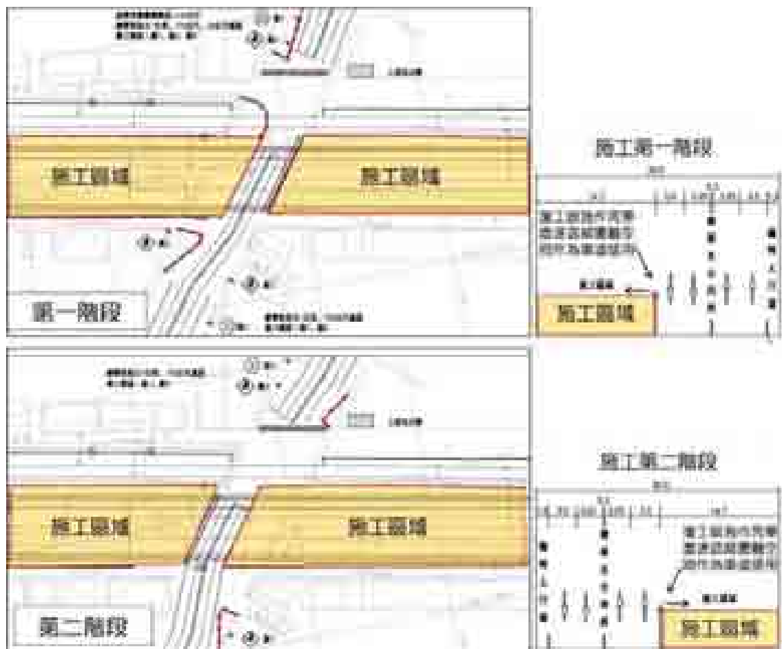
圖 10.2-1 平交道半半施工階段示意圖
