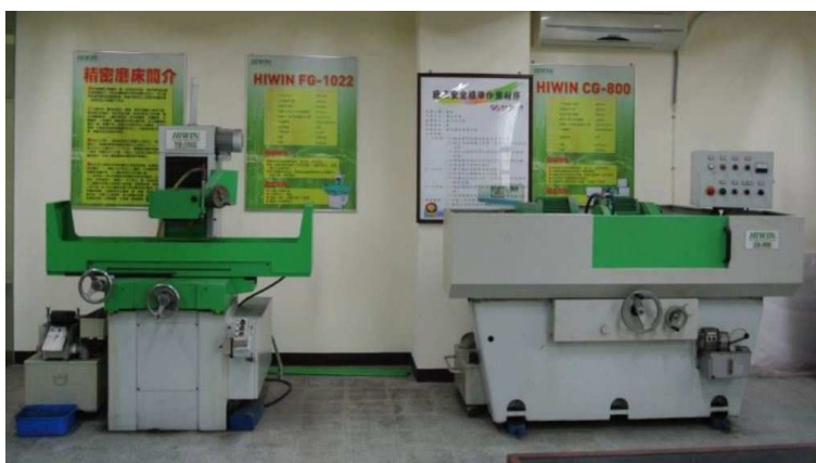
圖 2：企業捐贈圓筒磨床與平面磨床
