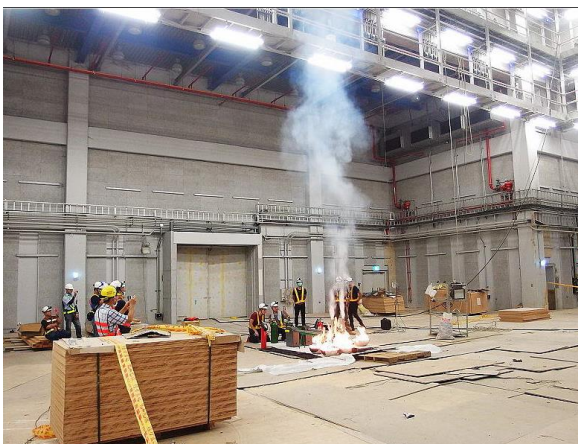
火災全尺度煙霧測試 (煙控模擬)
