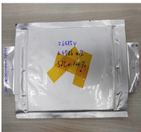
圖三、快充型電芯高溫循環測試
