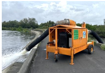
大型移動式抽水機
