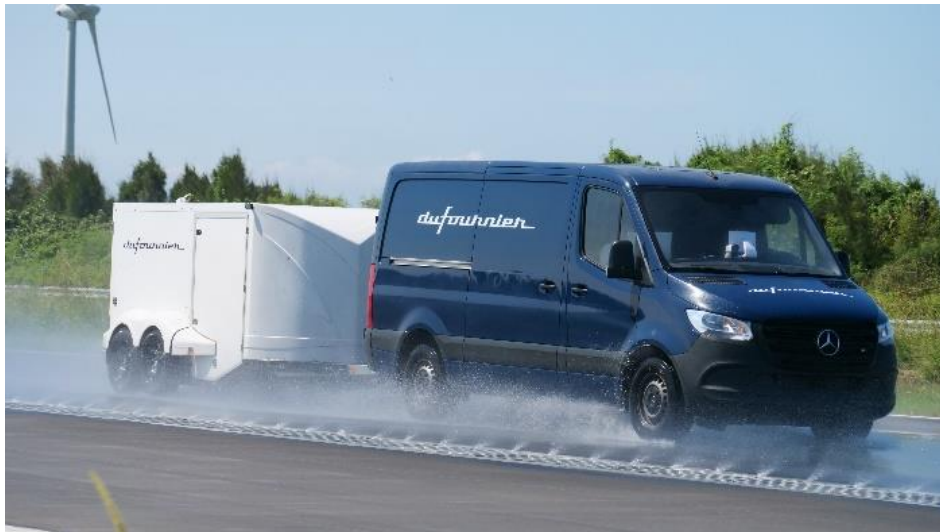
圖 14 輪胎溼地抓地力檢驗證驗能量，圖為小型拖車暨測試道
