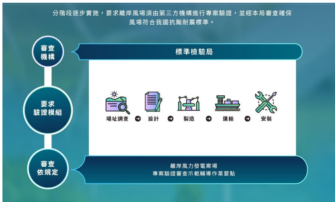
圖 12 本局針對國內離岸風場開發進行專案驗證審查，包含場址調查、設計、製造、運輸及安裝階段
