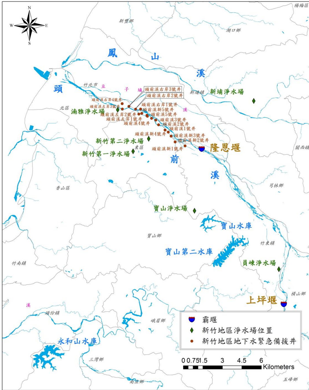
圖 3 修正後新竹地區地下水緊急備援井網位置圖
