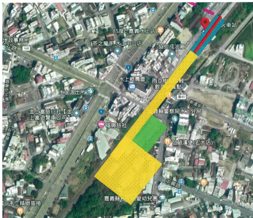
圖 3.5-2 水上車站布設大平台平面示意圖
