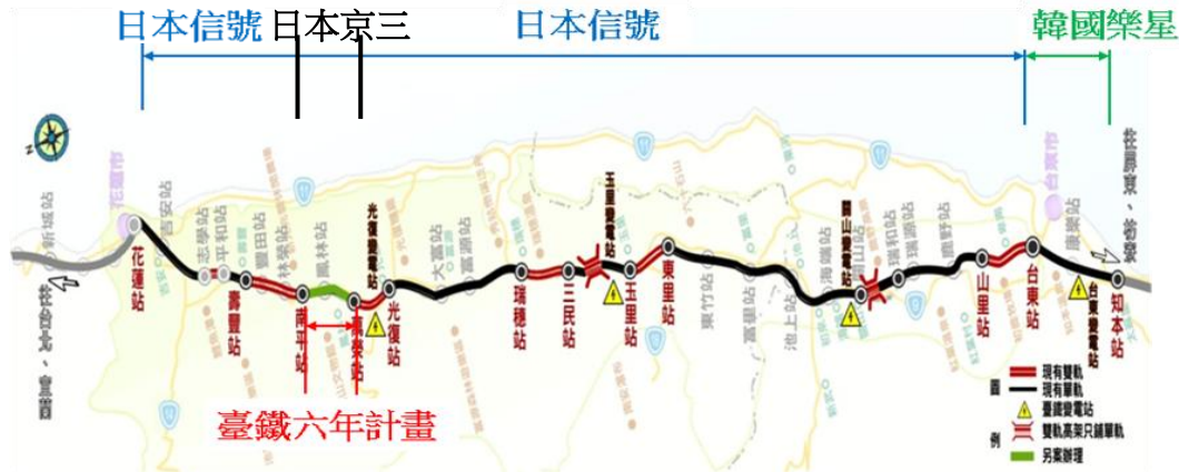
圖 4.2-5 花東線鐵路號誌電子聯鎖系統現況
