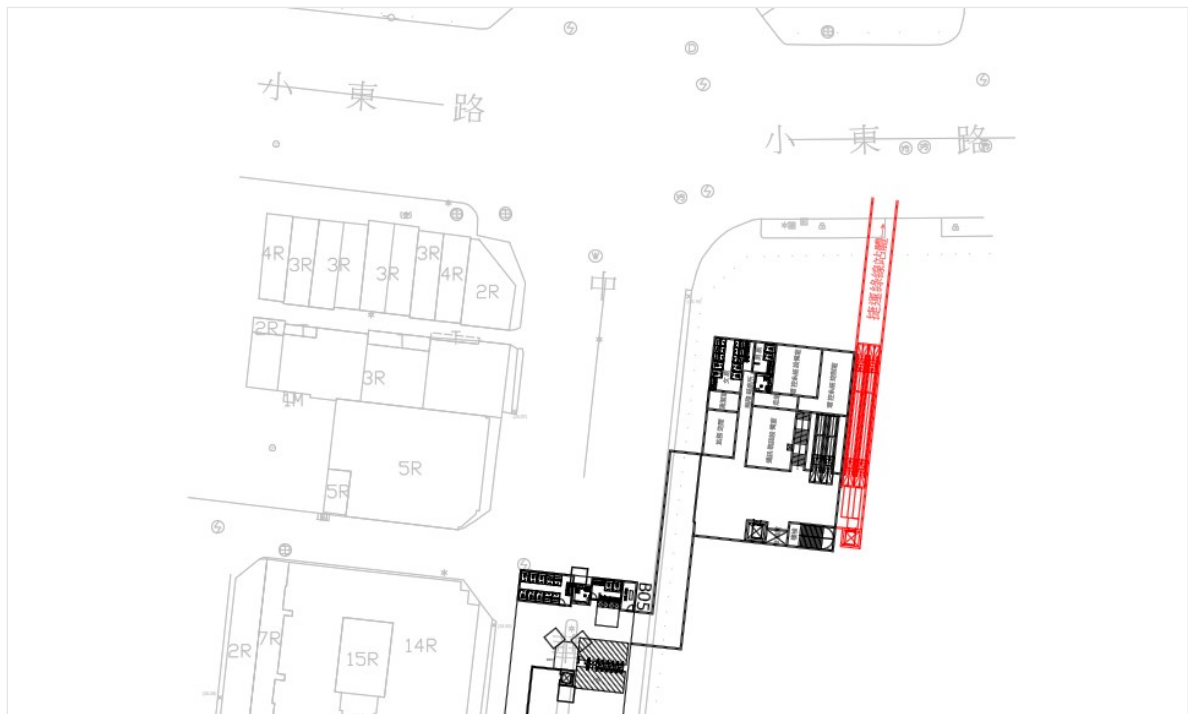
圖7-43 本計畫B04車站與綠線車站轉乘平面配置圖
