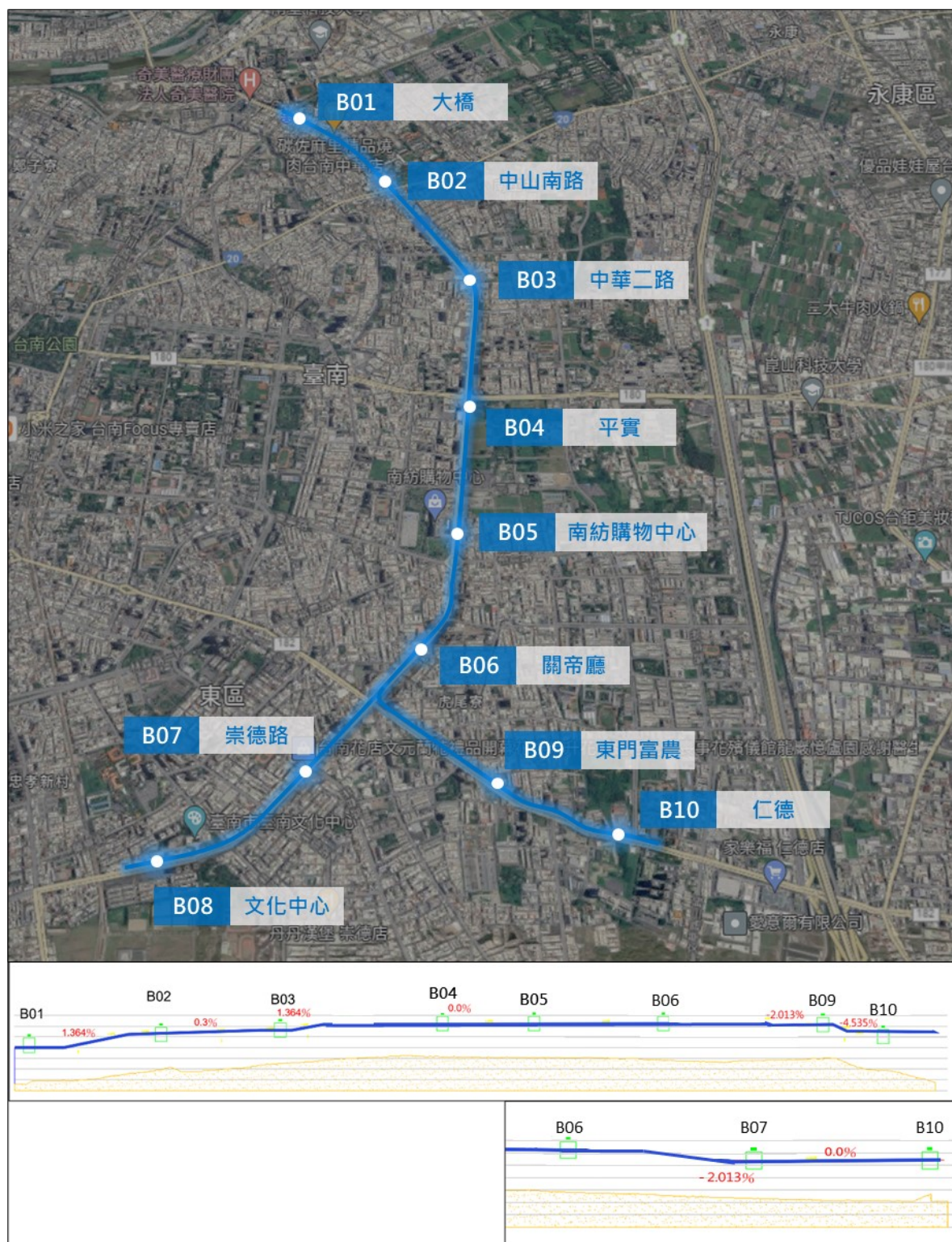
圖7-1 本計畫路線、站位配置及縱坡示意圖
