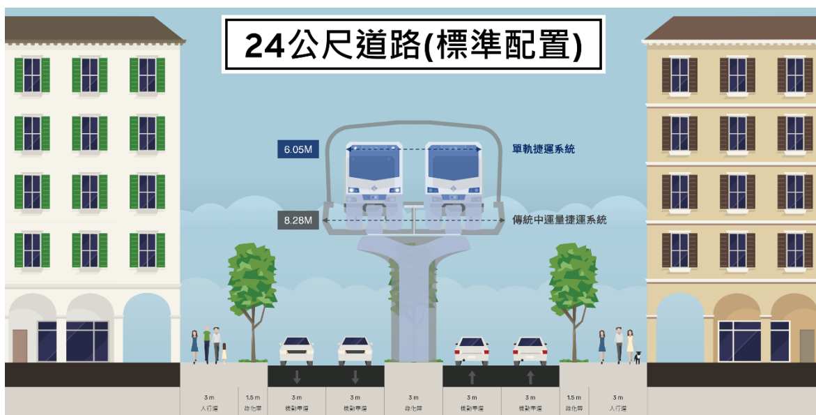
圖8-4 單軌捷運系統與傳統中運量捷運系統斷面比較圖
