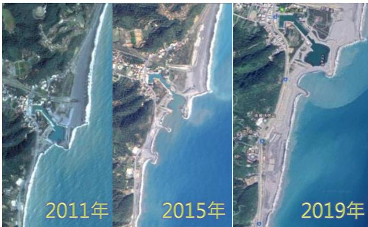
**大武漁港南側養灘** 隧道標開挖之土石方至大武漁港進行養灘工程，增生約100公尺寬沙灘。
