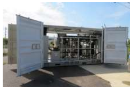
圖 2、電轉氣水電解產氫驗證設備
