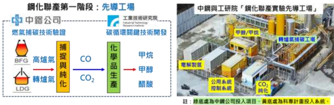
圖、與中鋼合作於小港廠建置「鋼化聯產實驗先導線示範場域」
