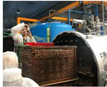
圖 7、殺菌釜熱分佈實際測試設備及情形
