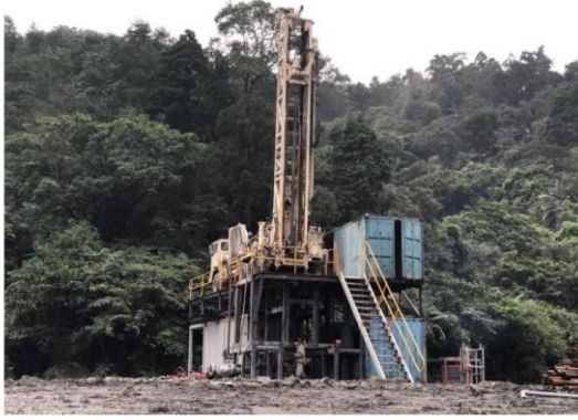
圖 10-3 泥漿鑽井工法
