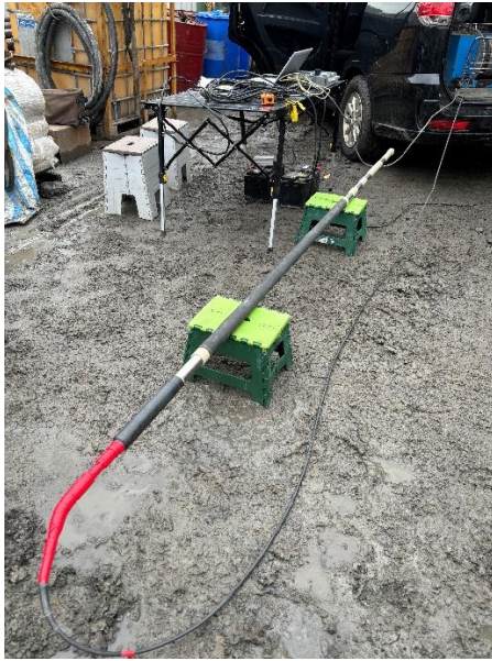
圖 4-9 花蓮瑞穗 2 號井進行井內測試，(a)井下溫壓探測儀，(b)溫度壓力初步量測成果
