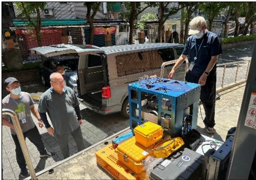
圖 4-14 完成重力儀與三軸拖鳥儀器地面功能測試。
