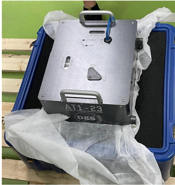
圖 10-2 本計畫已完成採購及組裝之空載重力探測系統(美國 Dgs 製造之 AT1A)
