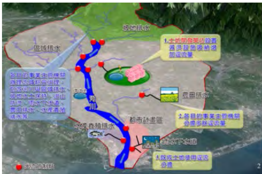
逕流分擔與出流管制概念流域示意圖
