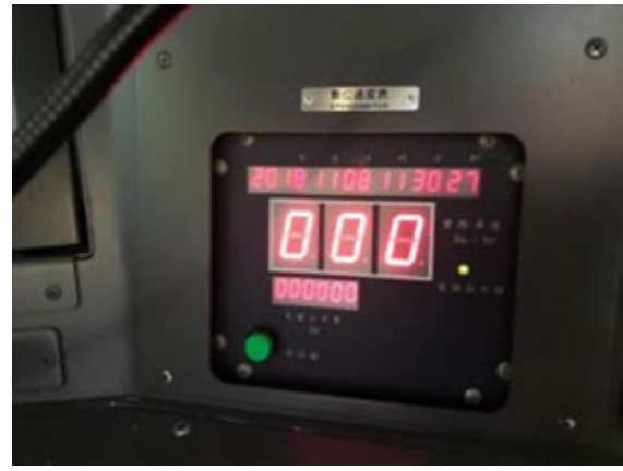
ATP 故障或隔離時車速顯示(數位車速表)
