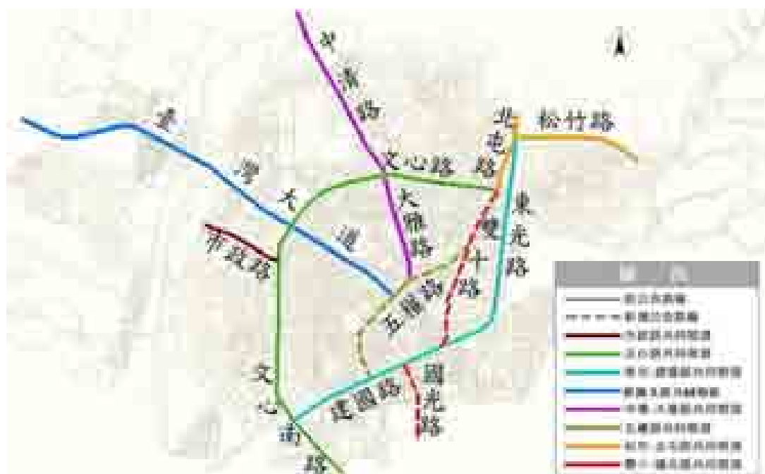
圖7.1-55 臺中市共同管道系統示意圖
