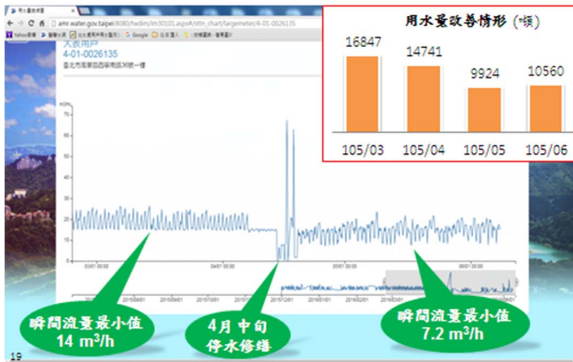
圖 5 利用瞬間流量最小值研判長期小量漏水情況
