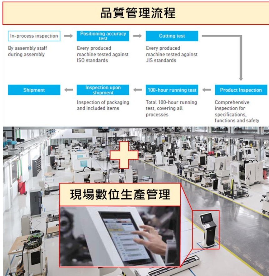
圖 5、全球工具機大廠 DMG Mori 數位化生產管理流程
