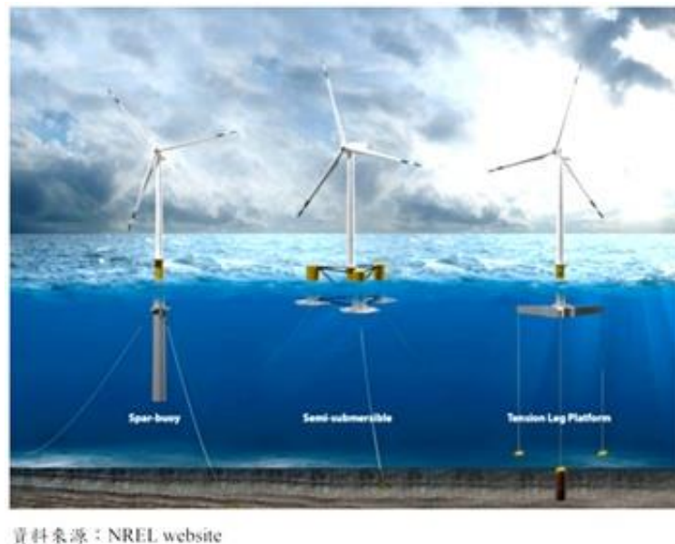
圖 4-4 浮體平台技術型式示意圖
