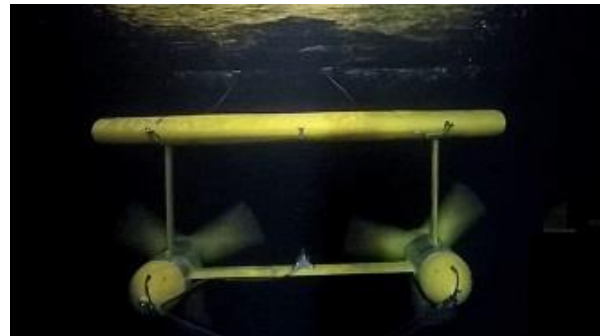
台大 800W 洋流發電渦輪機 實驗機組，2017
