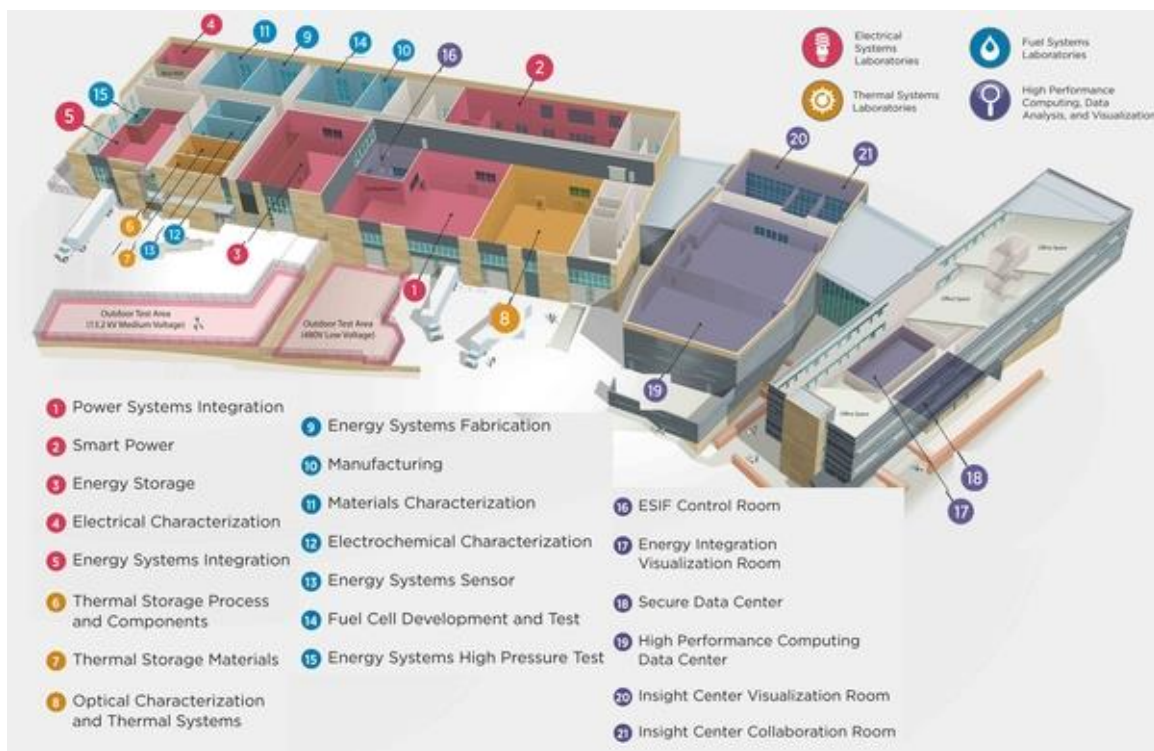
圖 11、美國國家再生能源實驗室能源系統整合核心設施布置圖
